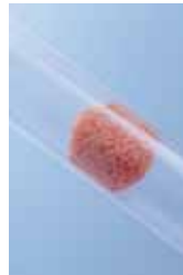
Abb. 12: Gepresste Schwammkugel im Leitungssystem
